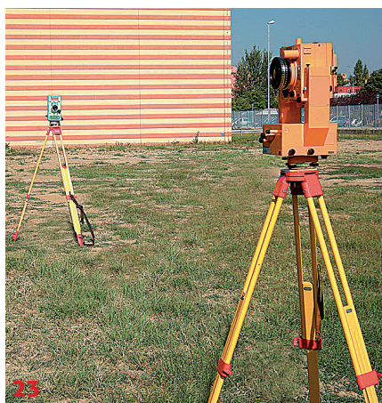
FIGURA 23 Operazioni di presa con camera metrica Zeiss UMK-10 (sul primo punto della base di presa) e teodolite elettronico per rilevare i punti di appoggio (collocato sul secondo punto della base).
